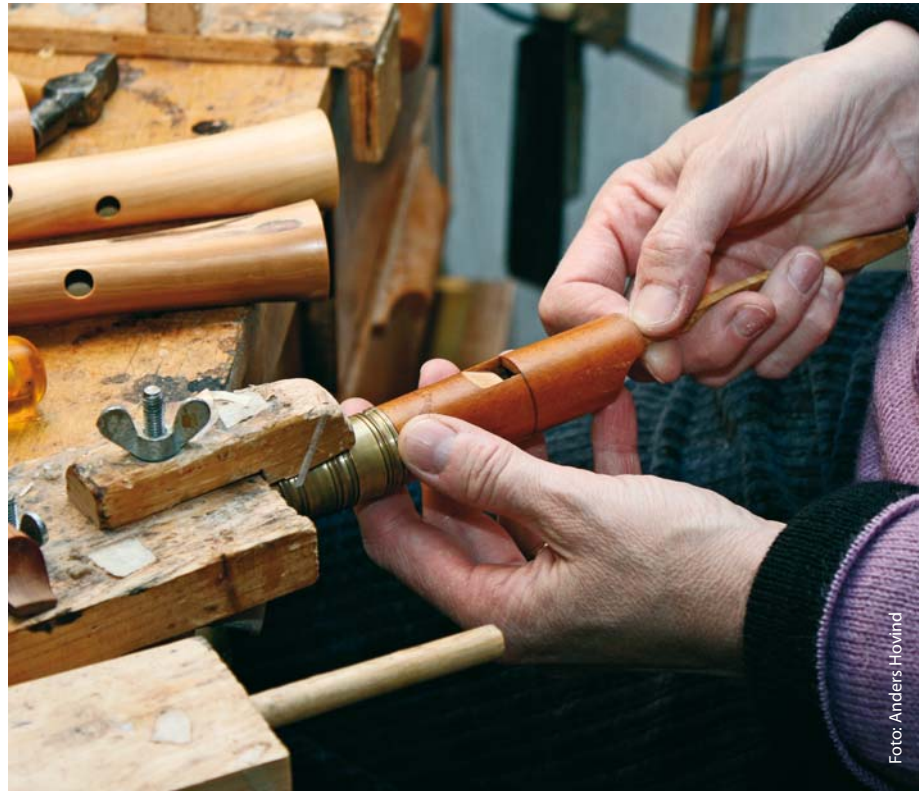
Alles von Hand: Die Arbeit am Windkanal erfordert größte Sorgfalt.
